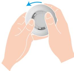
**i** Se necessitar de substituir a pilha, substitua-a por uma pilha Li-Mn CR14250.
